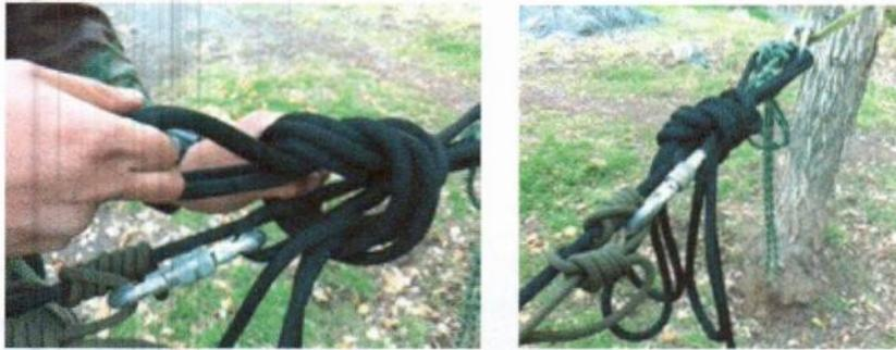
Fig. 4-26 Medio nudo o nudo de seguridad.
