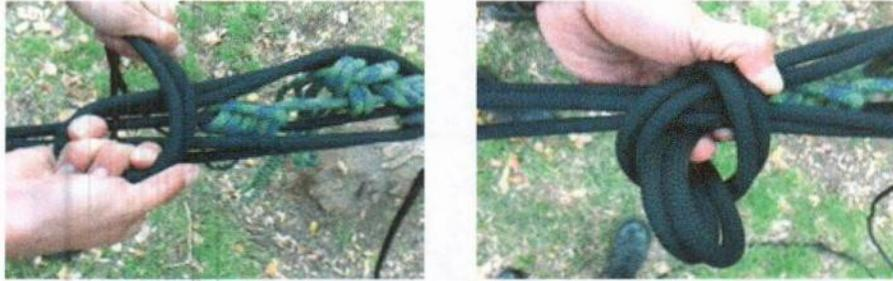
Fig. 4-25 Suelta rápida elaborada con la cuerda.
