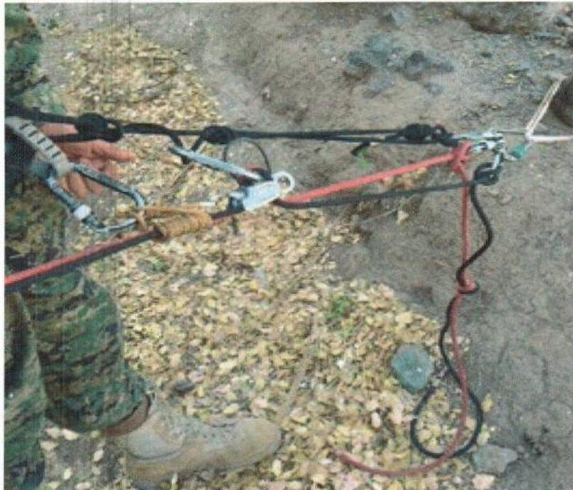
Fig. 4-4 Colocación del canastillo ATC.
