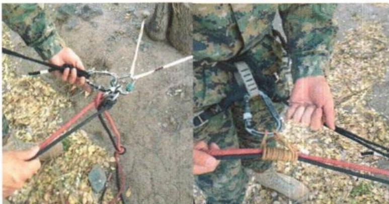
Fig. 4-3 Longe al mosquetón de servicio y colocación del nudo bloqueador.
